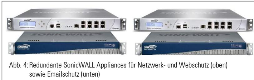
Abb. 4: Redundante SonicWALL Appliances für Netzwerk- und Webschutz (oben) sowie E-Mail-Schutz (unten)
